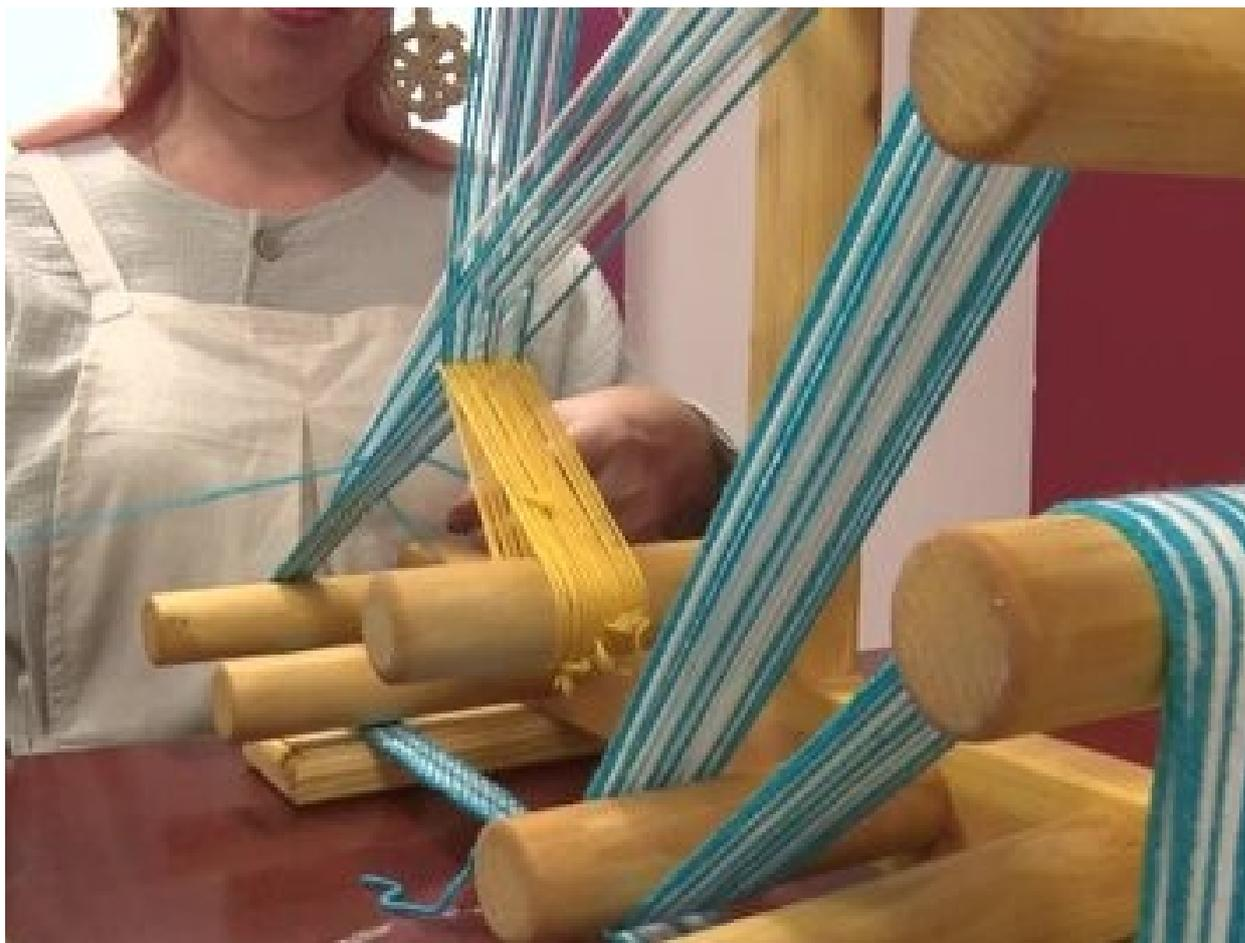
**Фотография 3: Заправка ручного лентоткацкого станка.**
